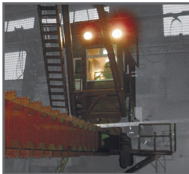
Кратцер-кран в комплексе по загрузке и разгрузке сыпучих материалов.
