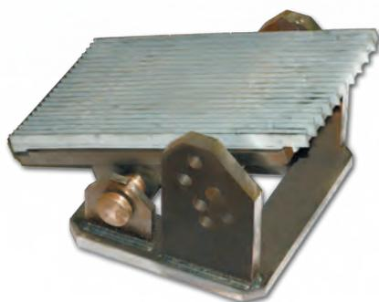
**Стенд испытания настила на скольжение**
