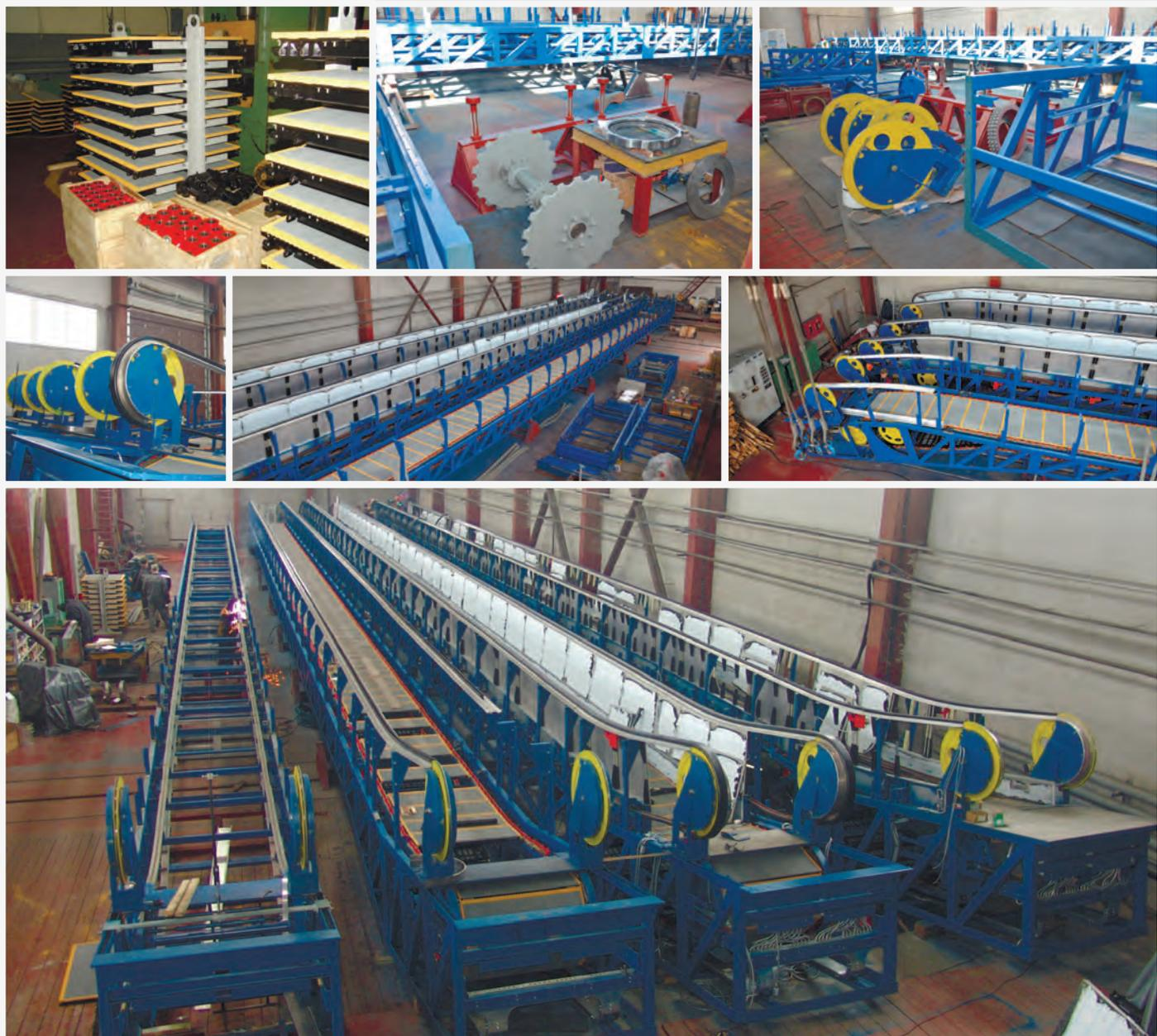
*Конвейер пассажирский КПБ-02М на испытаниях*
