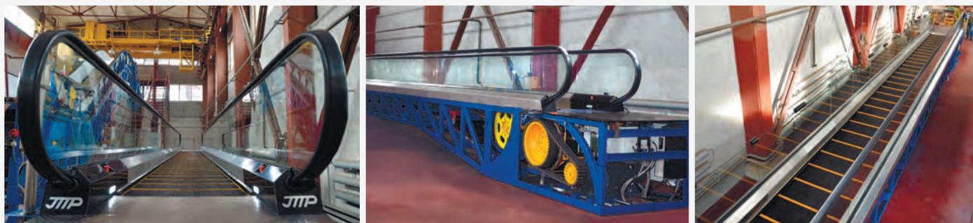
*Стендовый образец конвейера пассажирского КПБ-04М на испытаниях*
