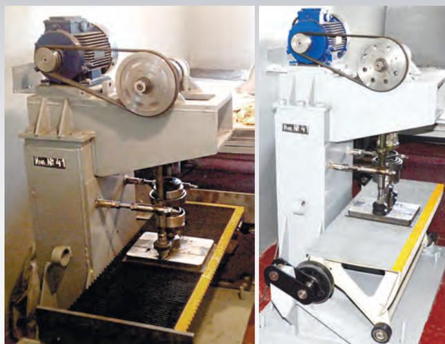
**Стенд динамического испытания ступеней и пластин**
